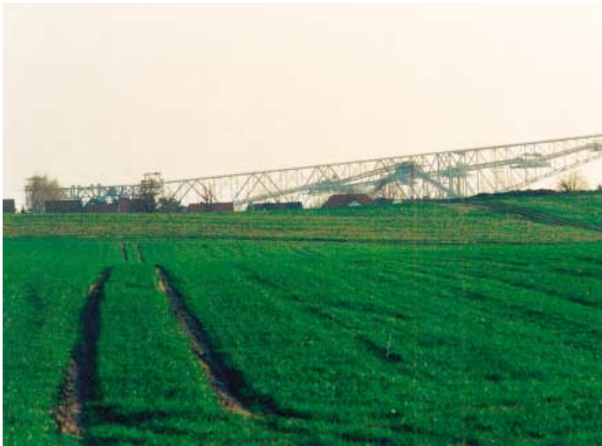
De F-60 is bijna twee keer zo groot als de Eiffeltoren. Toch was deze machine niet meer dan een transportband, en dan nog niet eens voor de bruinkool zelf, maar voor de 'onbruikbare' aarde erbovenop. Het echte werk werd gedaan door machines op de bodem van de mijn, machines die volledig in het niet vielen bij deze reus. Kleine treinen voerden vervolgens de bruinkool af.
