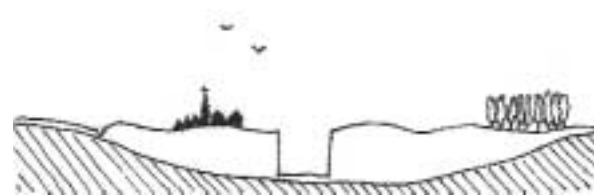
De grondwaterspiegel is verlaagd tot soms veertig meter diep om de mijnbouw mogelijk te maken. Een ingreep met invloed tot ver in de omgeving.
